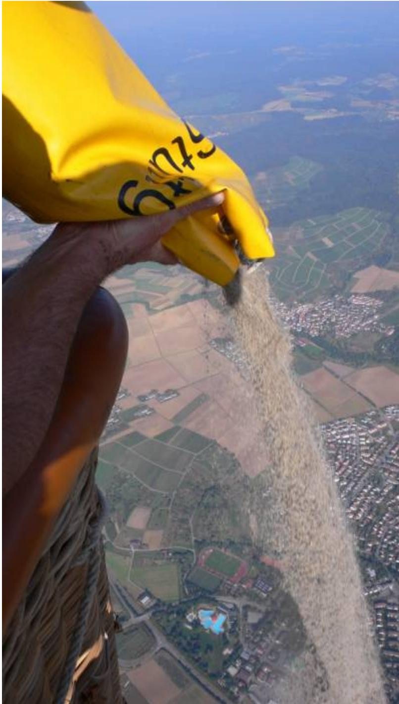
Die Sandsäcke werden zur Ballastabgabe nicht abgeworfen wie manchmal vermutet wird, sondern ausgeleert. Das Bild oben zeigt den umgedrehten Sack, und den herabfallenden Sand.
