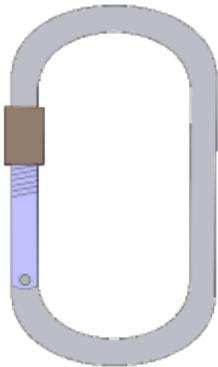
Mit Karabinern werden beim Ballon Seile verbunden oder befestigt. Beispielsweise werden die Hüllenseile mit dem Brennerrahmen und den Korbseilen verbunden. Weiter wird der Karabiner überall dort verwendet, wo Seile irgendwo eingehakt werden müssen, und zum Befestigen von Zubehör, beispielsweise Taschen. Der Karabiner wird auch als Karabinerhaken bezeichnet.
