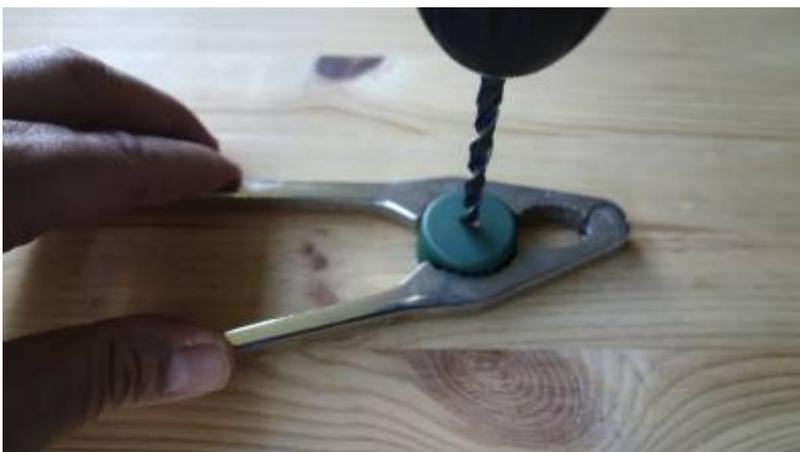
Zuerst wird ein Loch in den Deckel gebohrt. Der Durchmesser wird so gewählt, dass der Schlauch gerade hindurch passt. In die Dichtung ebenfalls eine Öffnung bohren oder schneiden, die zur Öffnung im Deckel passt.
