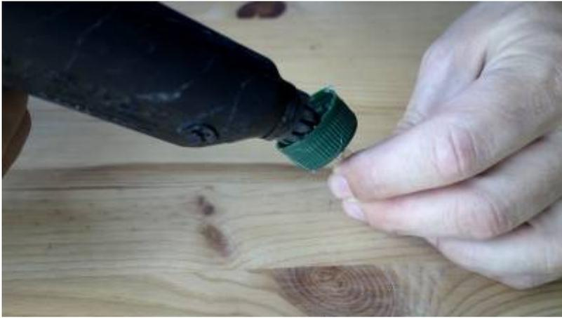
Anschließend wird die Öffnung innen auch mit Heißklebstoff abgedichtet.
