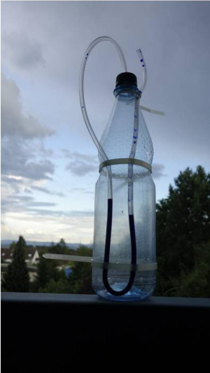
Um den Höhenmesser an einem Standort auf Null zu setzen, wird der Schraubverschluss kurz geöffnet, damit ein Druckausgleich stattfinden kann.
