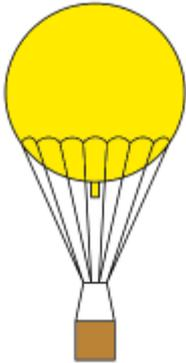
Ein Gasballon ist ein [Ballon](#), dessen [Tragkraft](#) durch die Differenz der Gewichtskraft eines [Gases](#) leichter als [Luft](#) zum [Auftrieb](#) (der Gewichtskraft der verdrängten Umgebungsluft) erzeugt wird. Am häufigsten wird als [Traggas](#) [Wasserstoff](#) verwendet, sehr selten das Edelgas [Helium](#). In Deutschland wurde bis in die sechziger Jahre des 20. Jahrhunderts [Stadtgas](#), auch als Leuchtgas genannt, verwendet. Bis dieses Kokereigas durch [Erdgas](#) ersetzt wurde.
