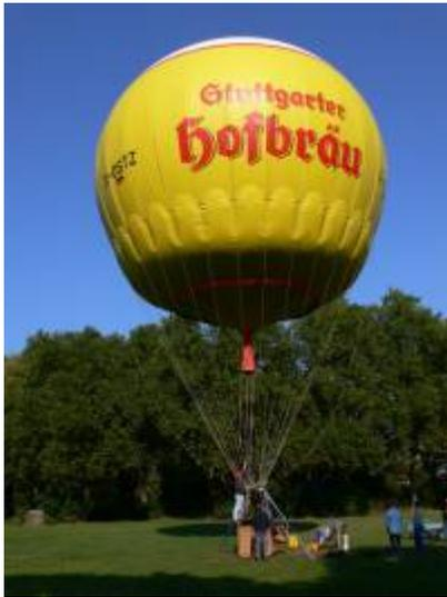
Seit 1992 wurden von den Ballonherstellern keine Gasballone mit Netz mehr gebaut, es wurden nur noch netzlose Gasballone hergestellt. Der entscheidende Vorteil des netzlosen Gasballons ist seine einfache Handhabung beim Füllen. Im Bild ein eintausend Kubikmeter großer Gasballon des Musters NL-1000/STU, hergestellt von der Firma [Ballonbau Wörner GmbH](#) in Augsburg.
