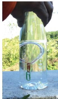
Funktionen. Zum einen sorgen sie dafür, dass die Schlauchöffnungen unten bleiben. Zum anderen wird mit ihnen der Ballon ausgewogen. Er soll nur soviel Steigkraft haben, das er gerade noch im Wasser schwimmt. Es ist einfacher, das Auswiegen in einem offenen Gefäß durchzuführen.
