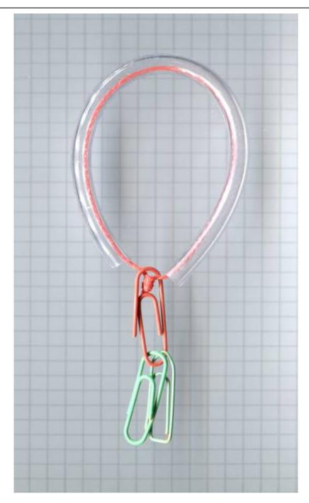
Ensuite, les trombones sont attachés au fil en bas. Les trombones ont deux fonctions. D'abord, ils s'assurent que les ouvertures du tube restent en bas. L'autre est d'équilibrer le ballon. Il ne doit pas avoir une puissance ascensionnelle telle qu'il ne fasse que flotter dans l'eau. Il est plus facile d'équilibrer le ballon dans un récipient ouvert.
