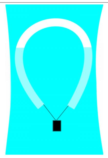
Lorsque le ballon est dans la bouteille fermée, la pression augmente lorsque la bouteille est pressée. L'augmentation de la pression comprime la bulle d'air dans le tube et le volume générant la flottabilité diminue - le ballon coule. D'autre part, si vous diminuez la pression sur la bouteille, la pression dans la bouteille diminue et la bulle d'air dans le tube peut se dilater - la flottabilité augmente et le ballon monte.
