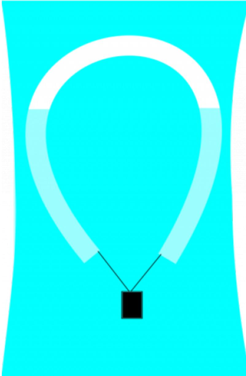
Lorsque le ballon est dans la bouteille fermée, la pression augmente lorsque la bouteille est pressée. L'augmentation de la pression comprime la bulle d'air dans le tube et le volume générant la flottabilité diminue - le ballon coule. D'autre part, si vous diminuez la pression sur la bouteille, la pression dans la bouteille diminue et la bulle d'air dans le tube peut se dilater - la flottabilité augmente et le ballon monte.
