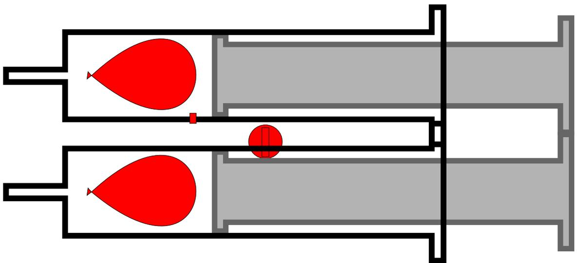
Dans le schéma du haut, le robinet est ouvert, l'air peut entrer et sortir librement de la seringue. La pression de l'air est la même à l'intérieur et à l'extérieur de la seringue.
