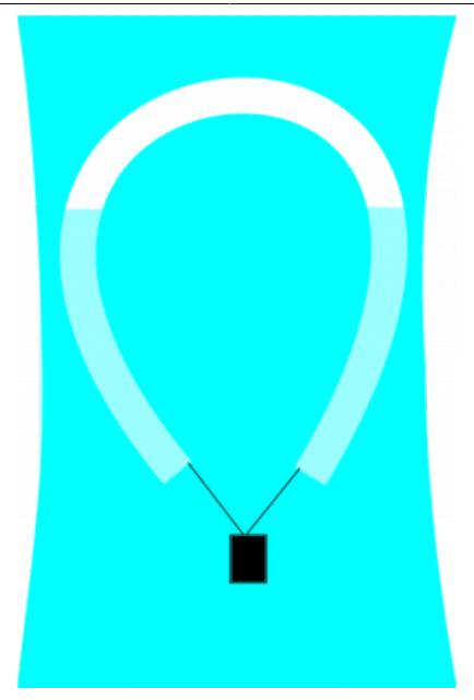
Wenn sich der Ballon in der verschlossenen Flasche befindet, erhöht sich der Druck wenn man die Flasche zusammendrückt. Durch die Druckerhöhung wird die Luftblase im Schlauch zusammengedrückt, und das den Auftrieb erzeugende Volumen verringert sich - der Ballon sinkt. Verringert man dagegen den Druck auf die Flasche, dann sinkt der Druck in der Flasche, und die Luftblase im Schlauch kann sich ausdehen - der Auftrieb erhöht sich, der Ballon steigt.
