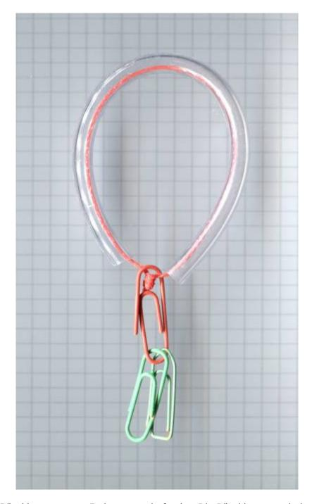
Dann werden die Büroklammern am Faden unten befestigt. Die Büroklammern haben zwei Funktionen. Zum einen sorgen sie dafür, dass die Schlauchöffnungen unten bleiben. Zum anderen wird mit ihnen der Ballon ausgewogen. Er soll nur soviel Steigkraft haben, das er gerade noch im Wasser schwimmt. Es ist einfacher, das Auswiegen in einem offenen Gefäß durchzuführen.
