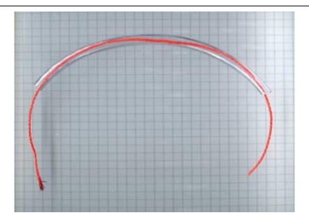
Zuerst wird der Schlauch in der gewünschten Länge zugeschnitten. Anschließend wird der Faden durch den Schlauch gezogen.
