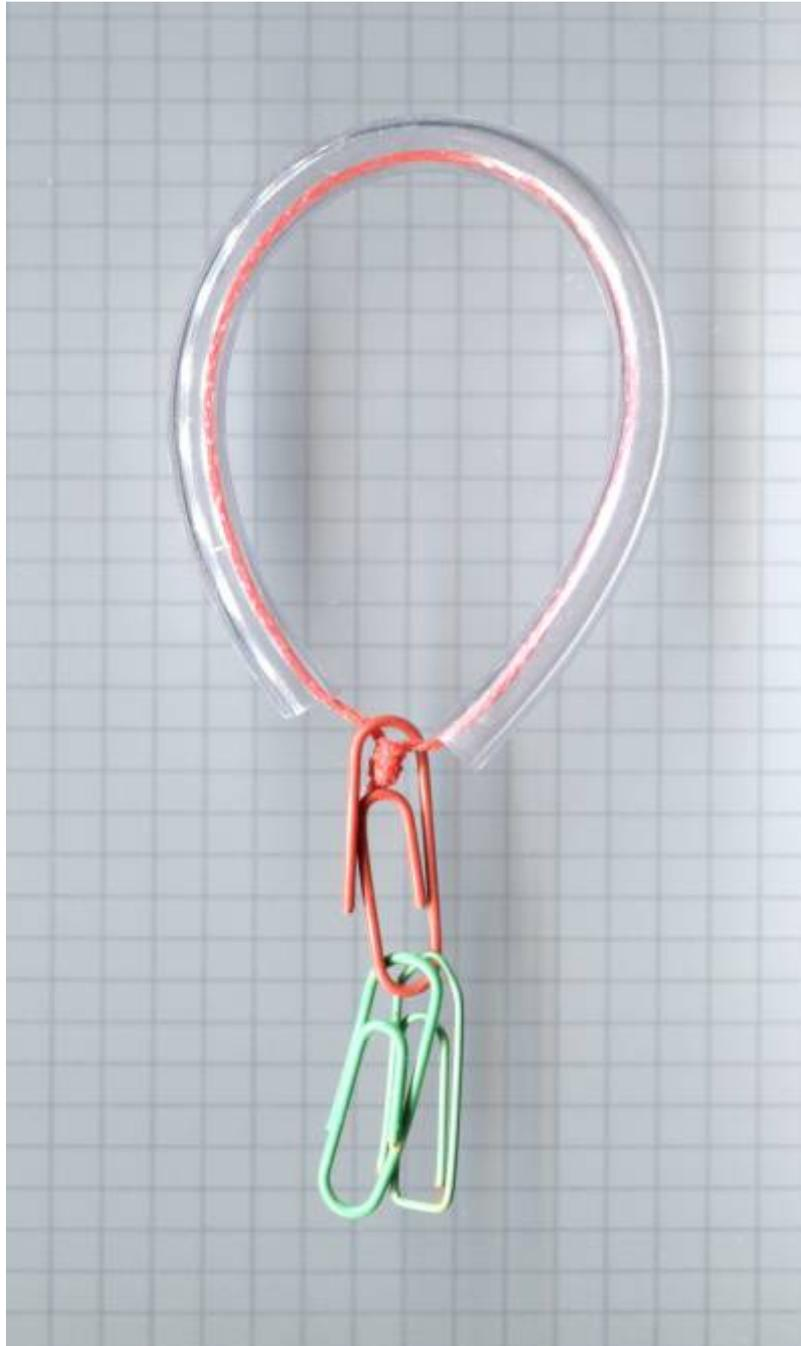
Dann werden die Büroklammern am Faden unten befestigt. Die Büroklammern haben zwei Funktionen. Zum einen sorgen sie dafür, dass die Schlauchöffnungen unten bleiben. Zum anderen wird mit ihnen der Ballon ausgewogen. Er soll nur soviel Steigkraft haben, dass er gerade noch im Wasser schwimmt. Es ist einfacher, das Auswiegen in einem offenen Gefäß durchzuführen.
