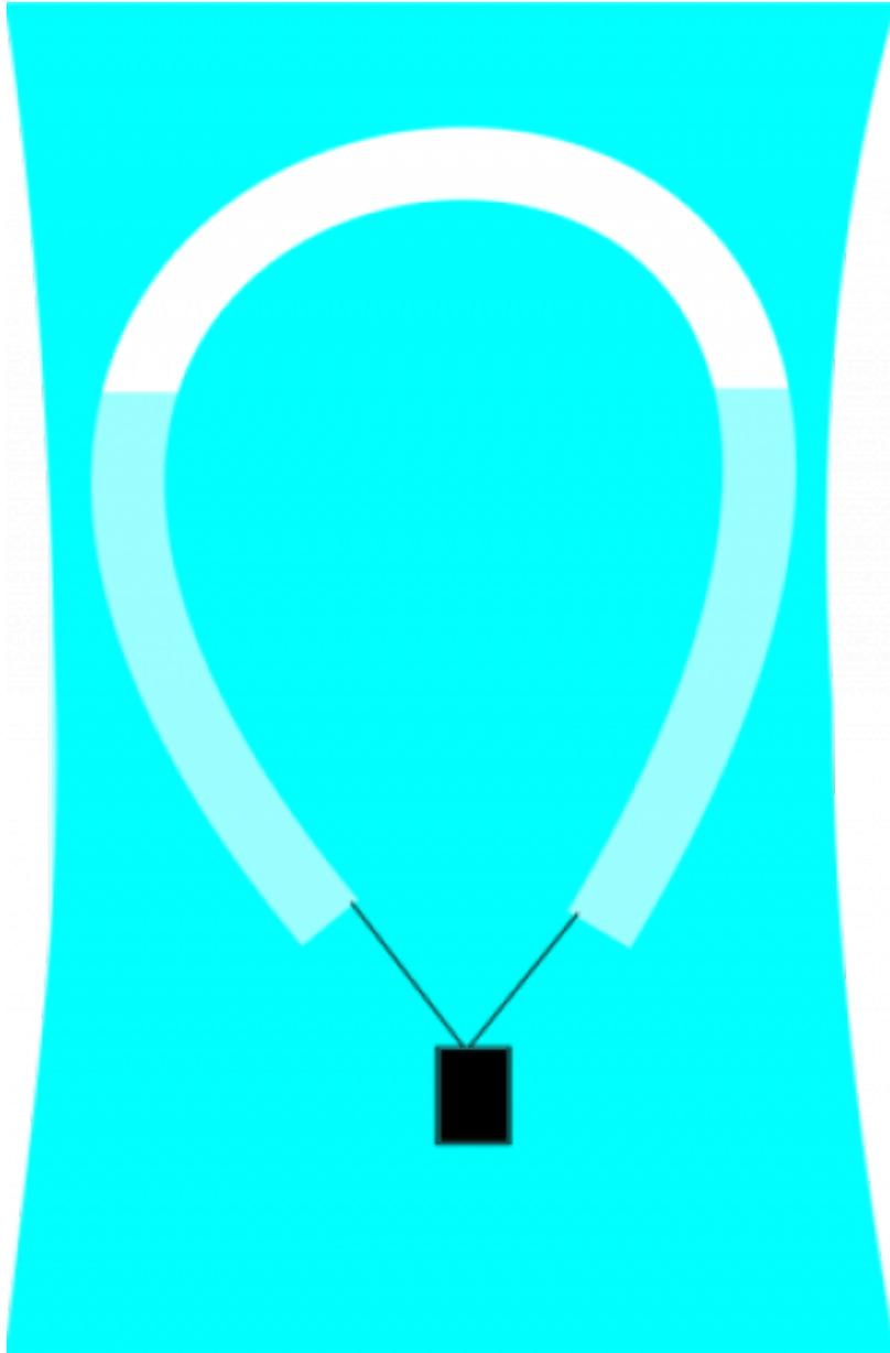
Wenn sich der Ballon in der verschlossenen Flasche befindet, erhöht sich der Druck wenn man die Flasche zusammendrückt. Durch die Druckerhöhung wird die Luftblase im Schlauch zusammengedrückt, und das den Auftrieb erzeugende Volumen verringert sich - der Ballon sinkt. Verringert man dagegen den Druck auf die Flasche, dann sinkt der Druck in der Flasche, und die Luftblase im Schlauch kann sich ausdehnen - der Auftrieb erhöht sich, der Ballon steigt.
