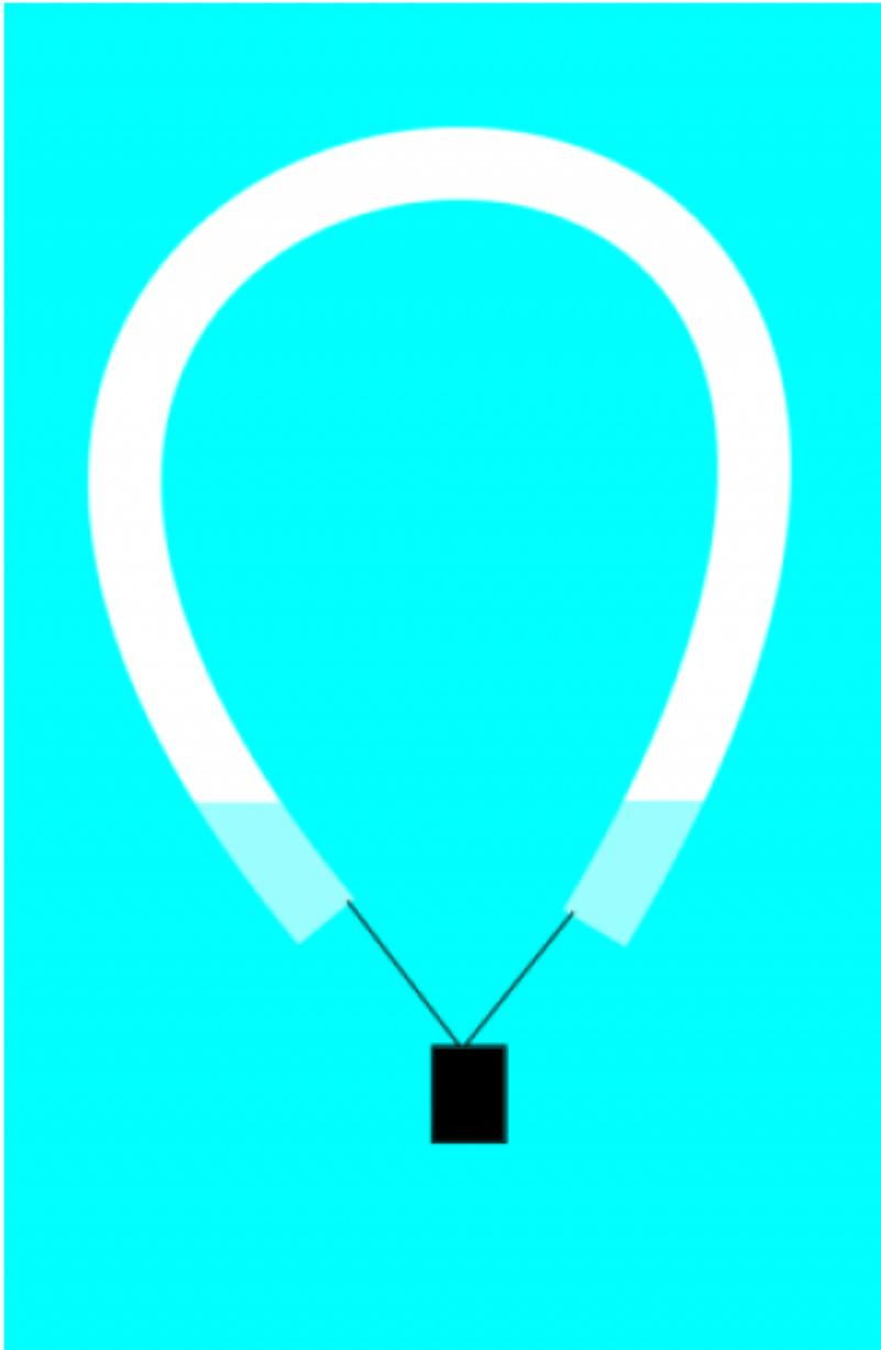
Wenn sich der Ballon in der verschlossenen Flasche befindet, erhöht sich der Druck wenn man die Flasche zusammendrückt. Durch die Druckerhöhung wird die Luftblase im Schlauch zusammengedrückt, und das den Auftrieb erzeugende Volumen verringert sich - der Ballon sinkt. Verringert man dagegen den Druck auf die Flasche, dann sinkt der Druck in der Flasche, und die Luftblase im Schlauch kann sich ausdehnen - der Auftrieb erhöht sich, der Ballon steigt.
