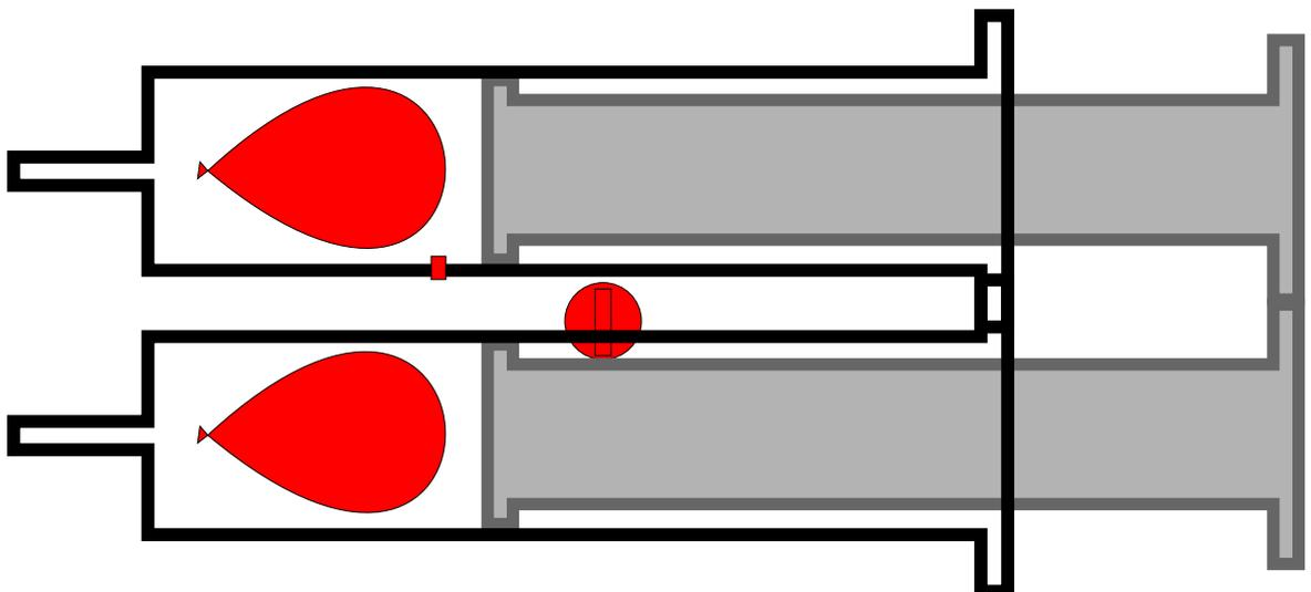
In der oberen Schemazeichnung ist der Hahn offen, Luft kann ungehindert in die Spritze hinein- und herausströmen. Innerhalb und außerhalb der Spritze herrscht der gleiche Luftdruck.
